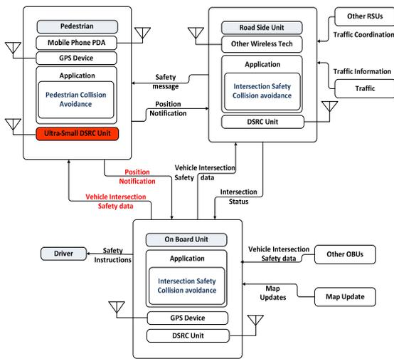
FIG.5. PEDESTRIAN COLLISION AVOIDANCE SYSTEM ARCHITECTURE
