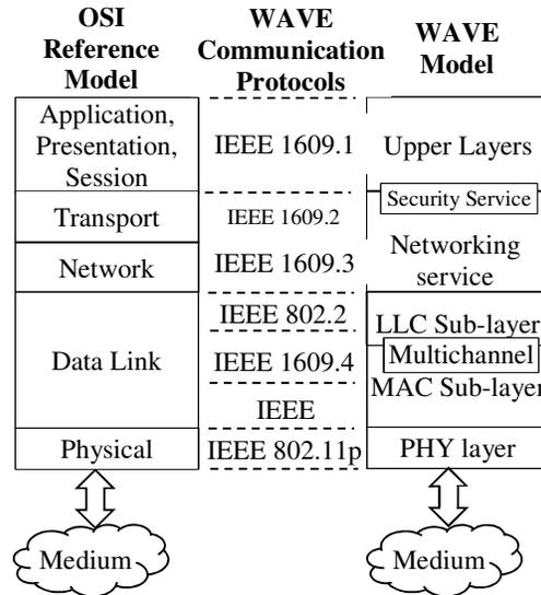
FIG.2. WAVE STANDARD ARCHITECTURE
